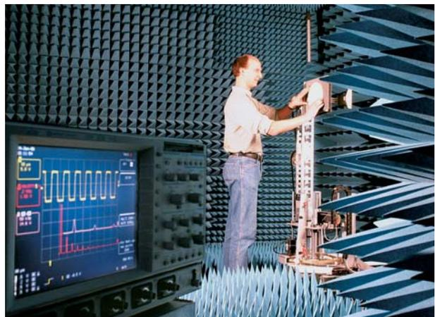
Messkammer für Millimeterwellen-Antennen mit rechnergesteuertem 4-Achsen-Drehstand
