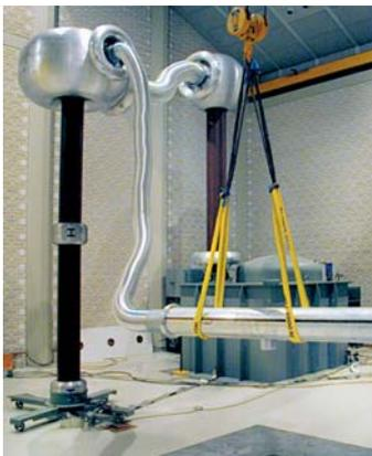
**Prüftransformator mit Koppelkondensator zur Teilentladungsmessung**
