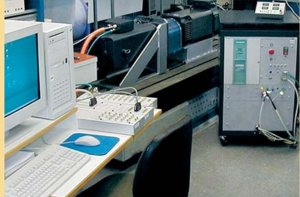
**Versuchsstand für den gerberlosen Betrieb der permanent-erregten Synchronmaschine mit Echtzeitentwicklungssystem, Motoren und Stromrichter**
