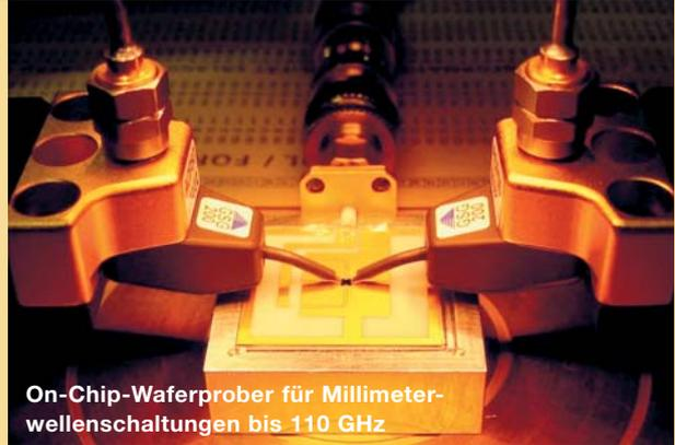
On-Chip-Waferprober für Millimeterwellenschaltungen bis 110 GHz
