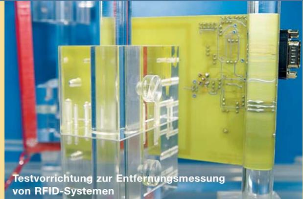
Testvorrichtung zur Entfernungsmessung von RFID-Systemen
